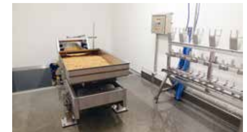
Garnalenaanvoer/halffabriek op de bovenverdieping (met valbeveiliging), waar de multihead-wegers staan voor het afvullen in consumentenverpakkingen.
